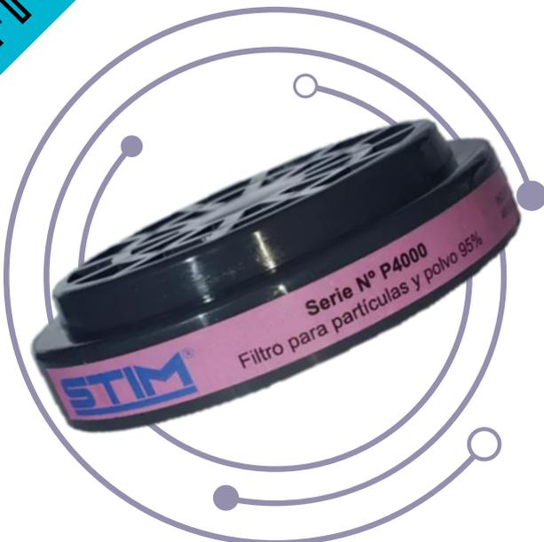
Los cartuchos STIM P4000, diseñados para medias máscaras S1100, S1200 y la máscara completa C5200, retienen el 95% de partículas. Hechos con triple capa de tela de alta calidad, aseguran un filtrado eficaz. Su base centrada permite un flujo de aire uniforme, extendiendo la vida útil de los filtros. Además, unidos a la pieza facial, distribuyen el peso de manera uniforme para mayor comodidad del usuario.
